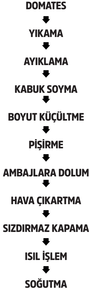
Şekil 2. Domates Sosu Üretimi Akış Şeması
