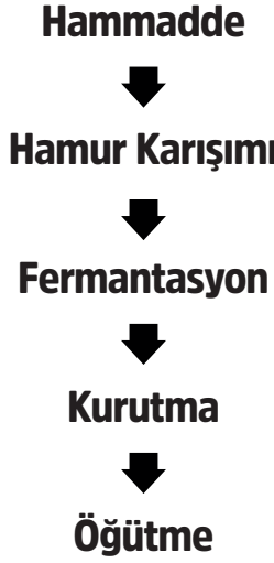
Şekil 1. Tarhana Üretim Aşamaları
